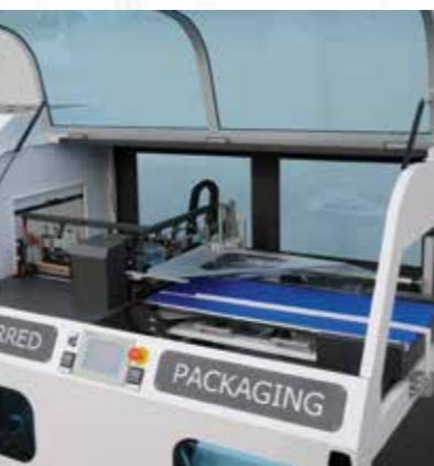
Der vertikale Schweißstempel in L-Form sorgt dafür, dass derselbe Druck auf die zu schweißende Folie ausgeübt wird und ersetzt so das alte Scherensystem. Eine gleichmäßige Schweißung wird erzielt.
