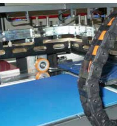
Schweißstempelbreite nur 1 cm, vertikale Bewegung und kein Scherensystem, einheitliches Schweißergebnis, geringer Folienverbrauch, niedrigere Schrumpfkosten.
