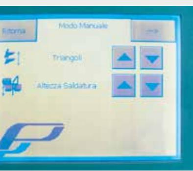
Einfacher Formatwechsel: Mittelschweißung und motorbetriebene Formschulter, Höhe bis zu 400 mm bei der größeren 790CS-Version. Siemens-Touchscreen. Einfaches Einstellen.
