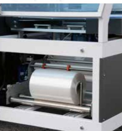
Folienlager und Einheit für die Folienabfallaufwicklung befinden sich beide vorne an der Maschine und sind somit leicht zuwänglich. Schiebetür.
